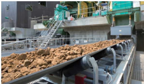
ベルトコンベヤで搬送される盛土材
