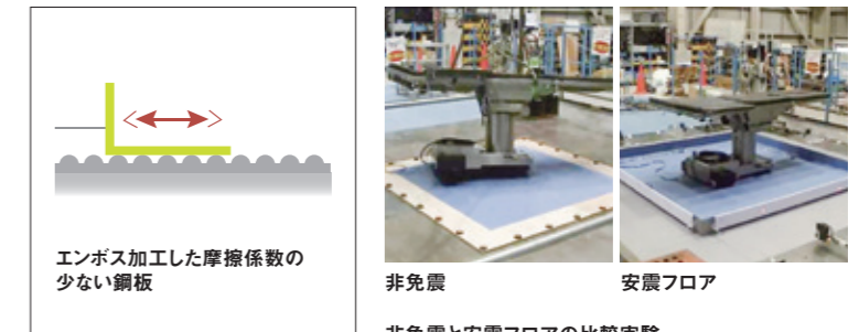
断面の構造 非免震と安震フロアの比較実験 揺れの大きさは一目瞭然。安震フロアなら安心です
