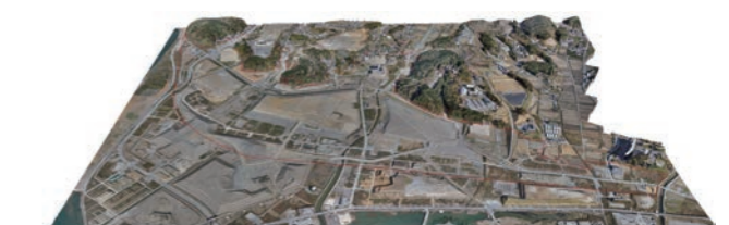
UAVで撮影した写真を基に作成した高田地区の3Dパース
