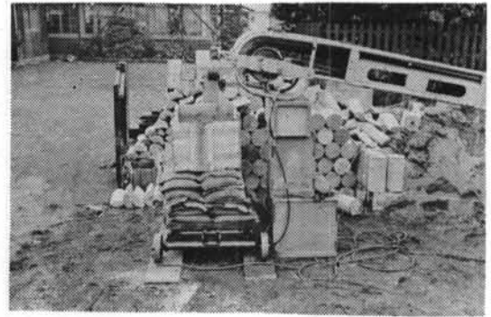
図-5 汎用コンベアによる自動計量の実験
