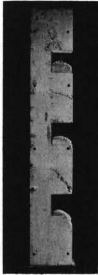
写真—3 cold joint ができた
