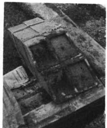
写真-14 自由収縮試験体(45°傾斜打設)
