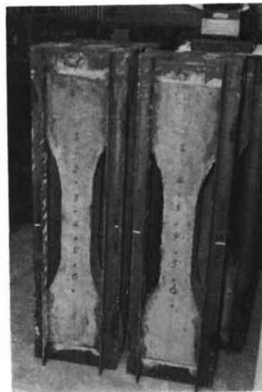
写真-1 拘束きれつ発生試験体
