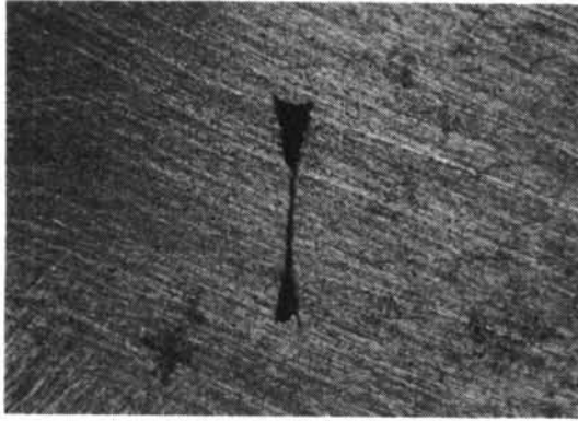
丸鋼径 19mm 溶接棒 D4301 (イルミナイト系) 径5.0mm アーク電流 210A
