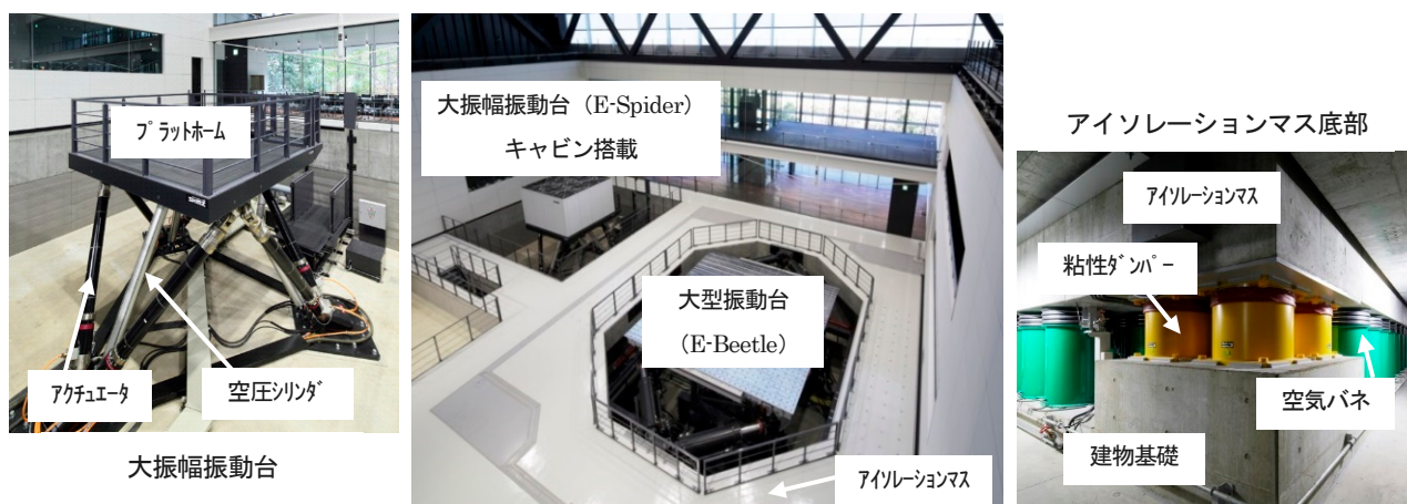
図-3 先端地震防災研究棟と2つの振動台
