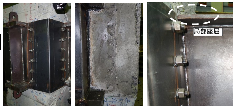
写真-1 試験体の終局状況
