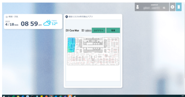
図-6 DX-Core 画面からの感染確率画像の閲覧 (センサーはフロアの一部にのみ設置)
