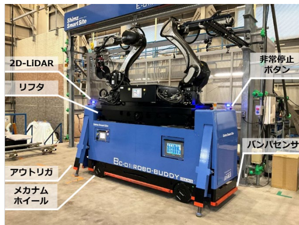
図-1 天井作業ロボット
