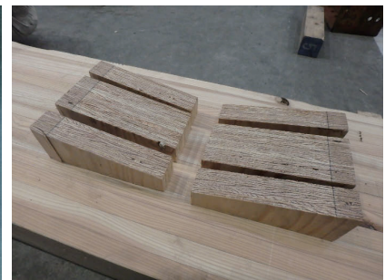
写真-3 試験体 J3B シリーズ の破壊性状
