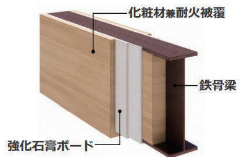
図-16 2 時間耐火木鋼梁の構成
