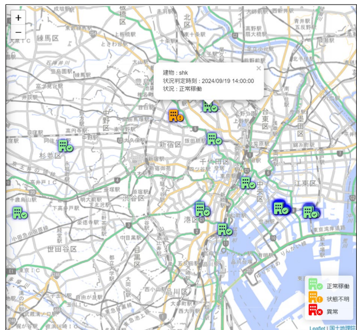
図-5 統合監視システムの画面表示例 (Web ブラウザ：観測機器ステータス)
