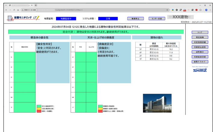
図-4 建物の健全度判定結果の画面表示例 (Web ブラウザ：上段には現在のシステム稼働状態表示)
