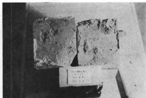
写真-17 打継面の状態 (アルミ粉末混入モルタル)
