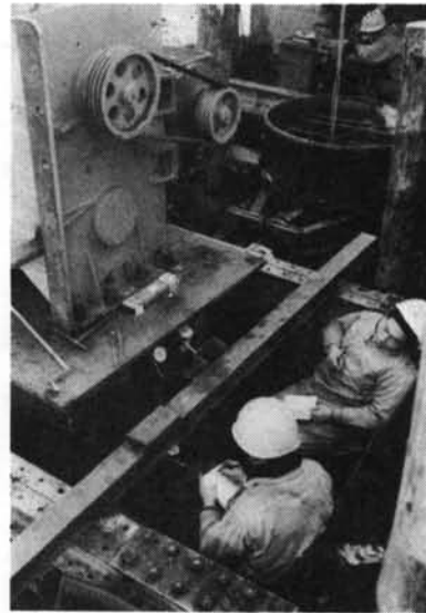
写真-5 単ぐい水平交番加力試験(測定状況)
