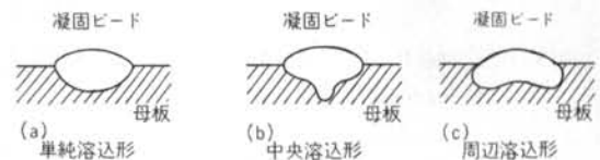
図一 溶け込み形状
