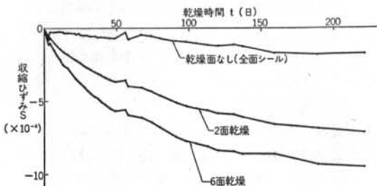
図-9 (VI; モルタル, 混和材B) の収縮ひずみ測定結果
