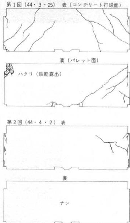
図-11(a) PC版建て起し時の亀裂(表・裏)状況図 (第1回~第2回)
