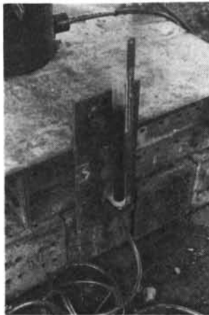
写真-2 沈下量測定装置 (水盛りの原理)
