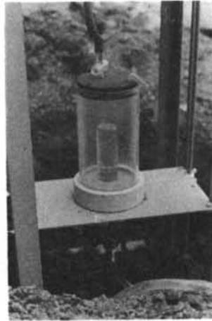
写真-3 水盛りの原理による基準点水そう装置
