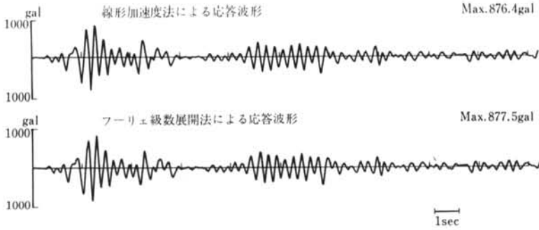
図—4 線形加速度法とフーリエ級数展開法による応答波形の比較 (Case III)
