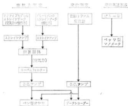
図-5 非正常空気力測定のブロック線図
