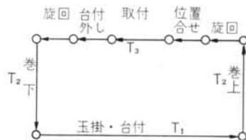
図-10 鉄骨建方サイクル
