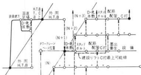
図-41 鉄骨～床版実施標準工程
