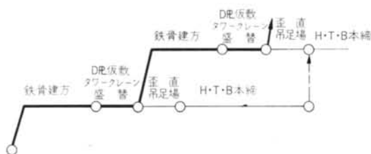
図-9 鉄骨建方フローチャート
