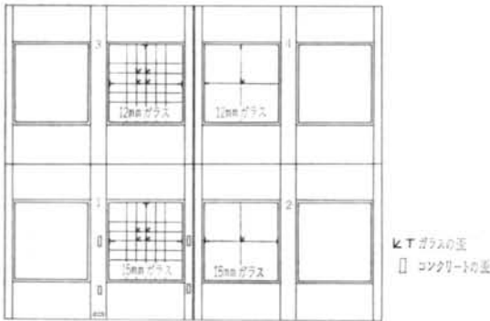
図—34 ガラスおよびコンクリートの歪測定位置
