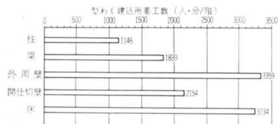
図-20 各部位の基準階1階分の型わく建込みに要する総工数
