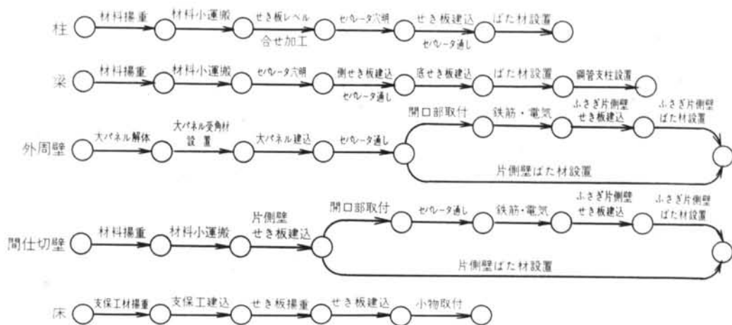
図一6 各部位の型わく建込工程
