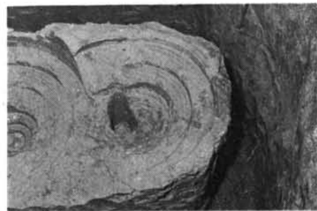
写真-6 S-2試験体歯型の清掃後の状況
