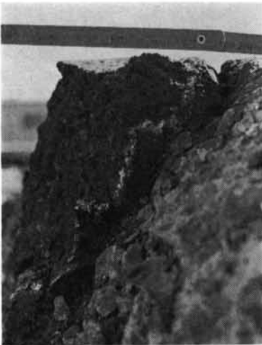
写真-2 S-2試験体下底面にみられるマッドケーキと地盤の断面
