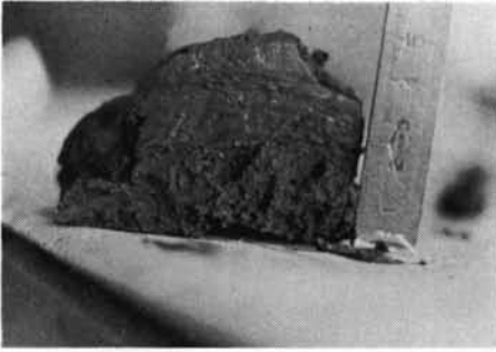
写真一七 ドリルの歯型から採取した沈殿物とマッドケーキの断面(下部に歯型の凹凸が認められる)
