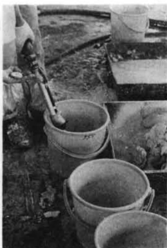
写真一5 各種プレミックスプラスターの吐出量の測定
