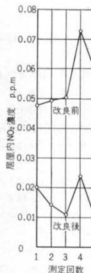
図-18 Sビル居室内のNO 2 濃度比較 (測定点3F2)
