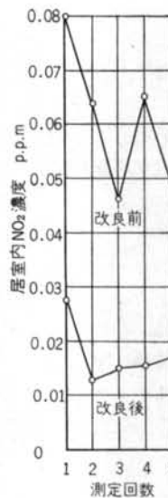
図-17 Sビル居室内のNO 2 濃度比較 (測定点2F1)
