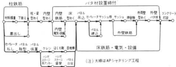
図-13 基準階1工区分の型わく工程
