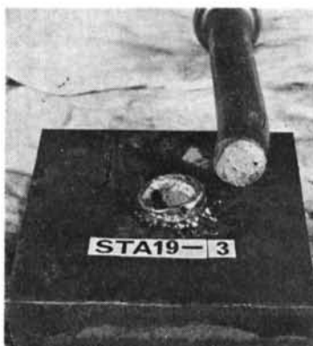
写真-2 テーパーワッシャ付引張試験結果 溶接金属部破断(不合格) 板厚19mm, 予熱なし
