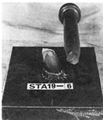
写真-1 テーパーワッシャ付引張試験結果 スタッド軸部破断(合格) 板厚19mm, 予熱なし
