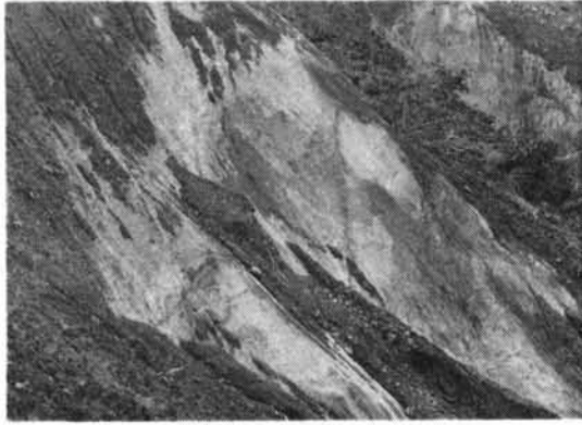
写真一五 仲木地区地すべりのすべり面となった基盤岩に印された条痕。
