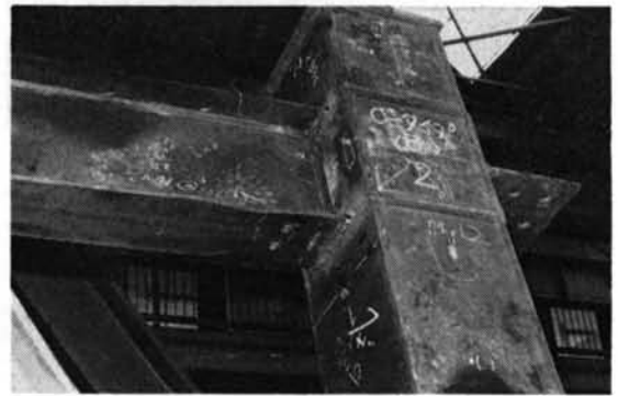
写真-6 Cタイプ最終状態（はりフランジ局部座屈）
