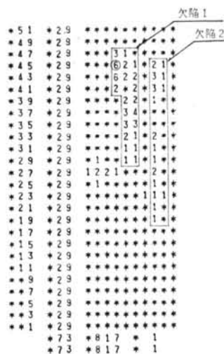
図-9 図-8の突合せ溶接部の探傷記録, スキャンナンバー①
