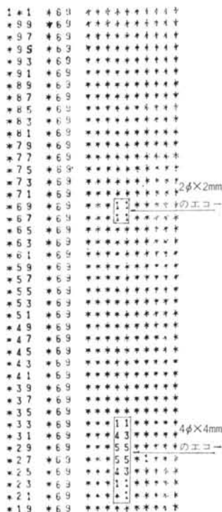
図-7 STB-A2の探傷, スキャンナンバー③
