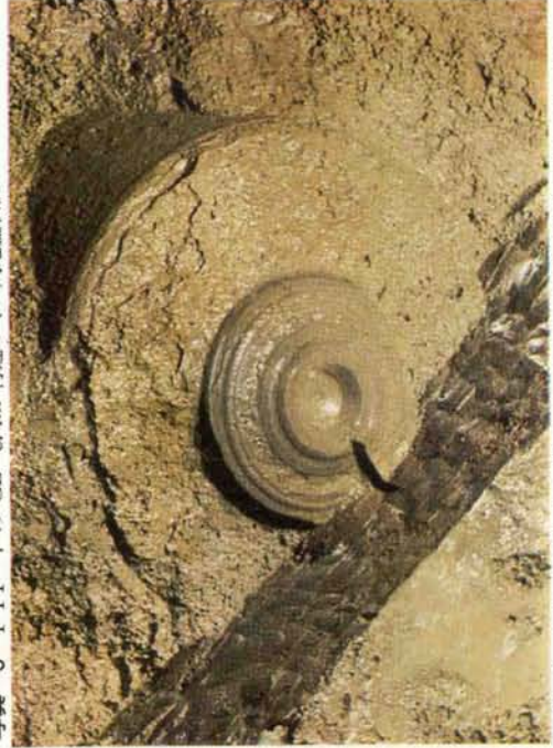
写真—6 地盤に形成された PIP くい先端部 (PIP-35) の跡 (中央の溝は排水のため後からつけたものである)
