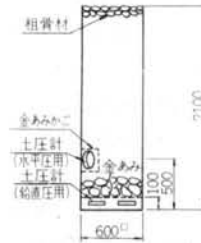
図-2 Gシリーズに用いた型枠および計測器の配置
