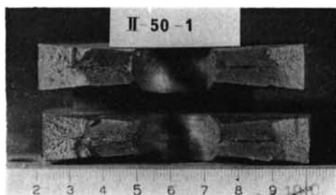
写真六 破断面：Ⅱタイプ、-50℃
