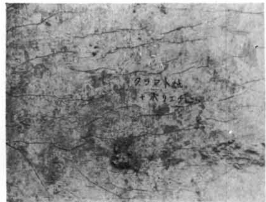
写-49 0.02mmポリエチレンライニングをほどこしたクラフト紙を、はくりシートに用いた場合のはくり面。小じわが多い。
