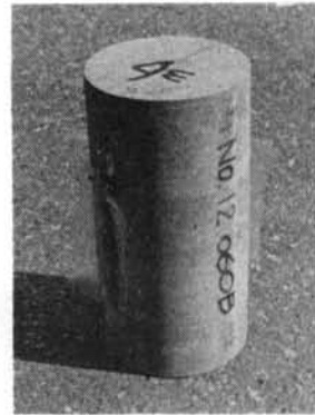
写真-8 コア-供試体：No.12杭，深度60cm
