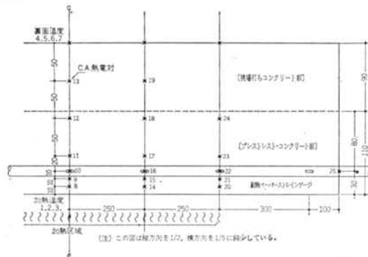
図-9 熱電対およびストレインゲージの埋込み位置
