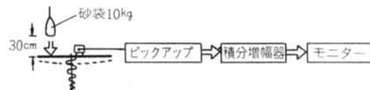
図-9 床スラブ振動測定方法
