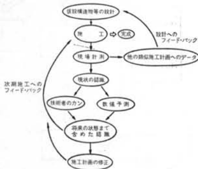
図-1 山止め計測管理
