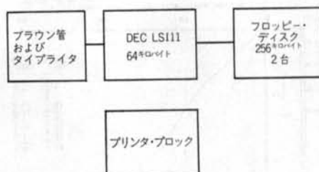
図一3 NATM 計測システムの構成
