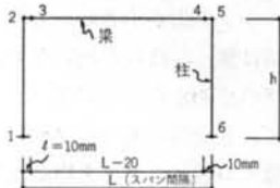
図-15 調整スパンがある場合の局部収縮量と相対変位量
