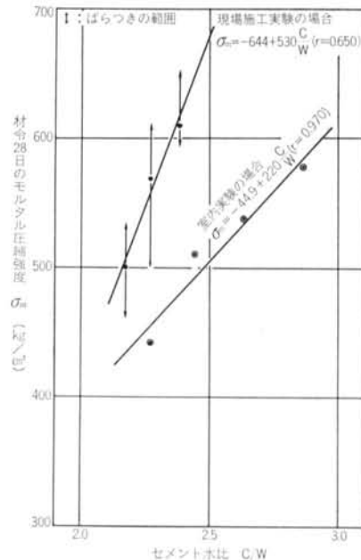
図-14 モルタルのセメント水比と圧縮強度の関係
