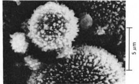
写真—9 石膏を添加したフライアッシュの表面構造 (A-6, A_G=2\% , t=28 日)
