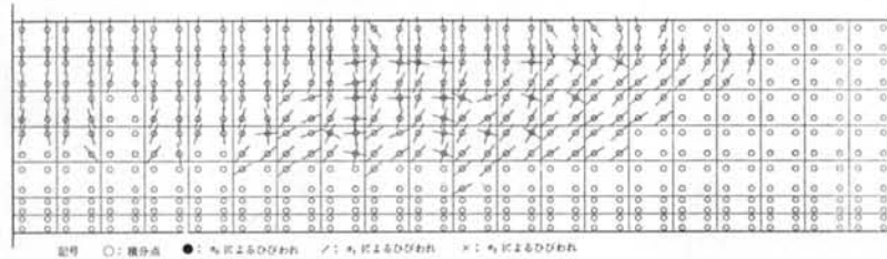
図-11 ひびわれ状況 (はり; UB-8-1.3-0)
