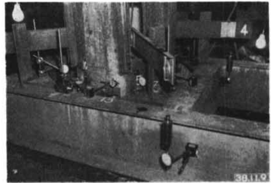
写真-5 ダイヤルゲージ取り付け状況
