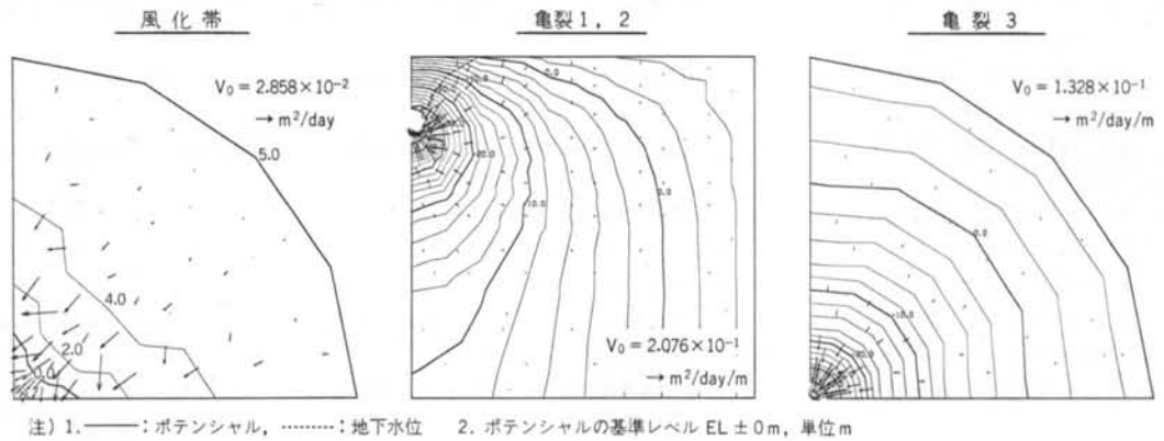
図一15 Case-1 の360日後のポテンシャルおよび流速分布
