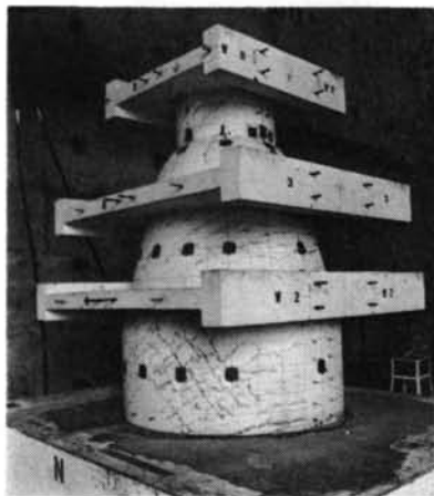
写真—4 シールドウォールの最終状況
