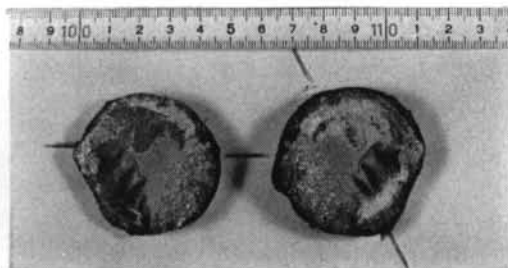
写真一 現場圧接体の圧接面破断面例
