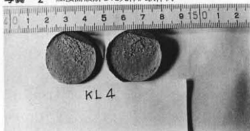
写真二 ノッチ入り曲げ破断面例
