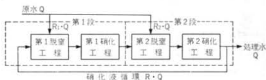
図-2 2段型循環脱窒法
